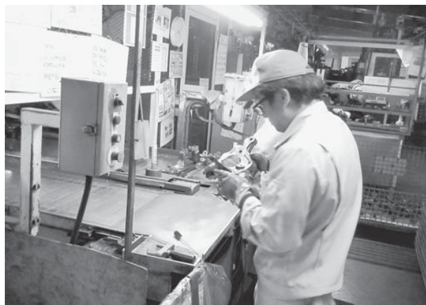
金属加工後に検査を行い、早い段階で不良品を取り除く
